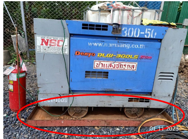
รูปที่ 2-14 การจัดเตรียมอุปกรณ์ป้องกันการรั่วไหลของน้ำมัน
