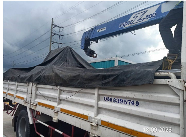
รูปที่ 2-5 การใช้ผ้าใบปิดคลุมรถบรรทุกขนย้ายวัสดุ
